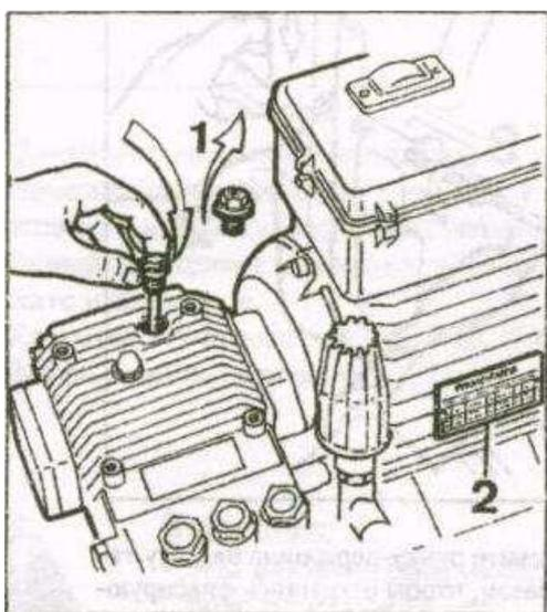
1. Замените красную транспортировочную крышку масляного бачка на постоянную, желтого цвета.
